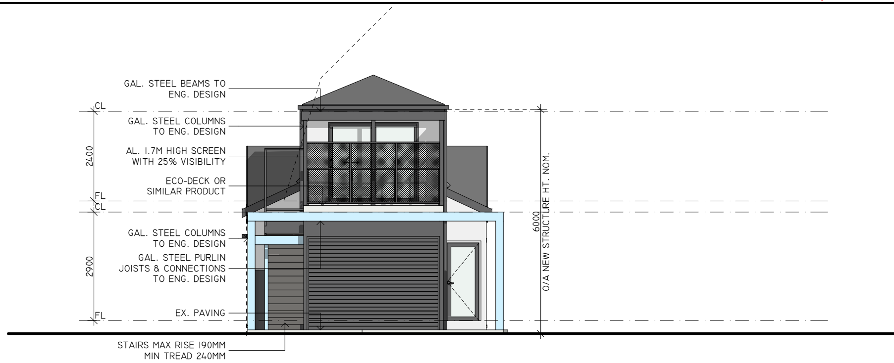
SOUTH ELEVATION SCALE: 1:100
